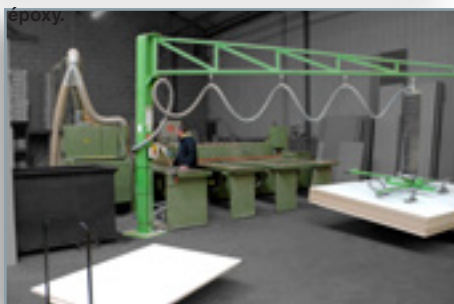
Débit des panneaux sur scie à commande numérique.
