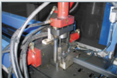
Débâts automatisés des tubes et poçonnages en continu.
