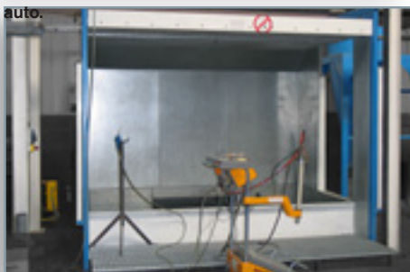
Chaîne d'application de poudres époxy.
